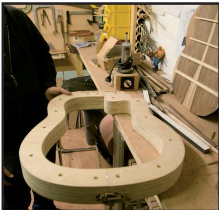
Contre-moule d'assemblage des éclisses
